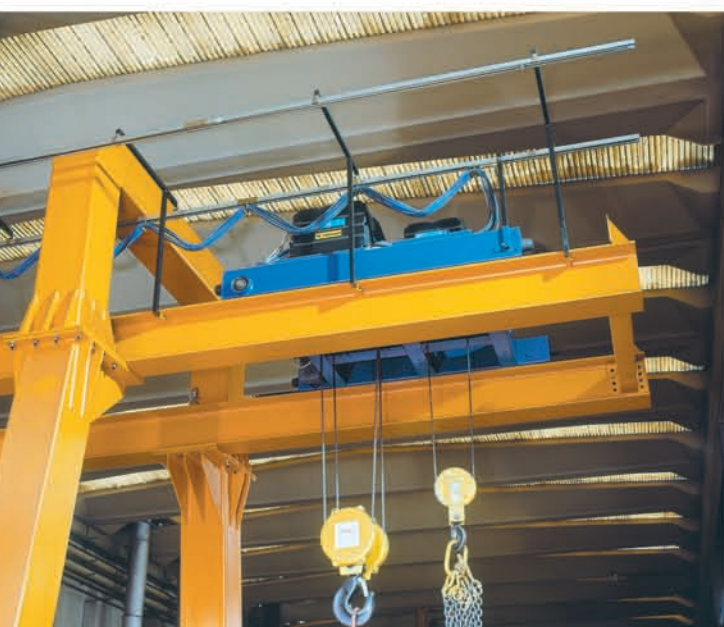
TTN-IVREA Gru a cavalletto zoppo con sbalzo a doppio paranco. Portata 15000/5000 Kg. Scartamento 8 mt.
