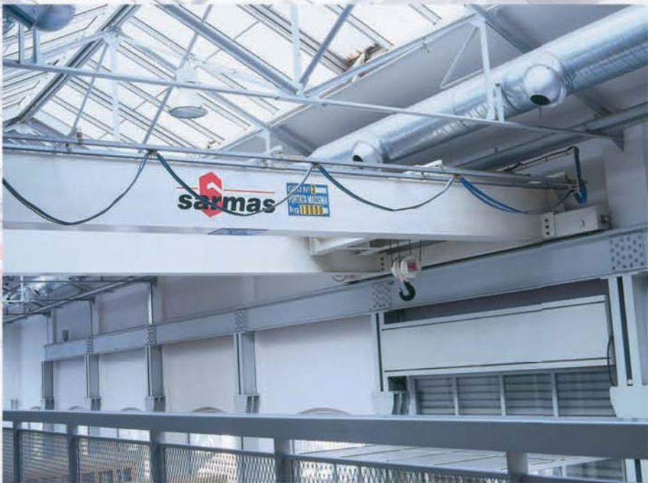
Fondazione Arnaldo Pomodoro-Milano. Carroponte bitrave a cassone. Portata 10000 Kg. Scartamento 10 mt.
