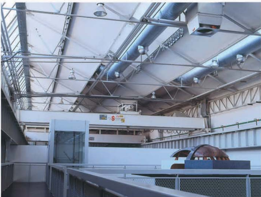
Fondazione Arnaldo Pomodoro-Milano. Carroponte bitrave a cassone Portata 10000 Kg. Scartamento 14 mt.
