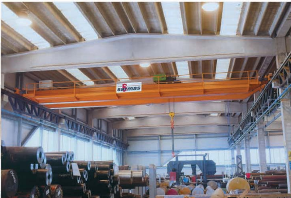
ITT-Nerviano (MI) Carroponte bitrave a cassone con passerella. Portata 15000 Kg. Scartamento 17 mt.
