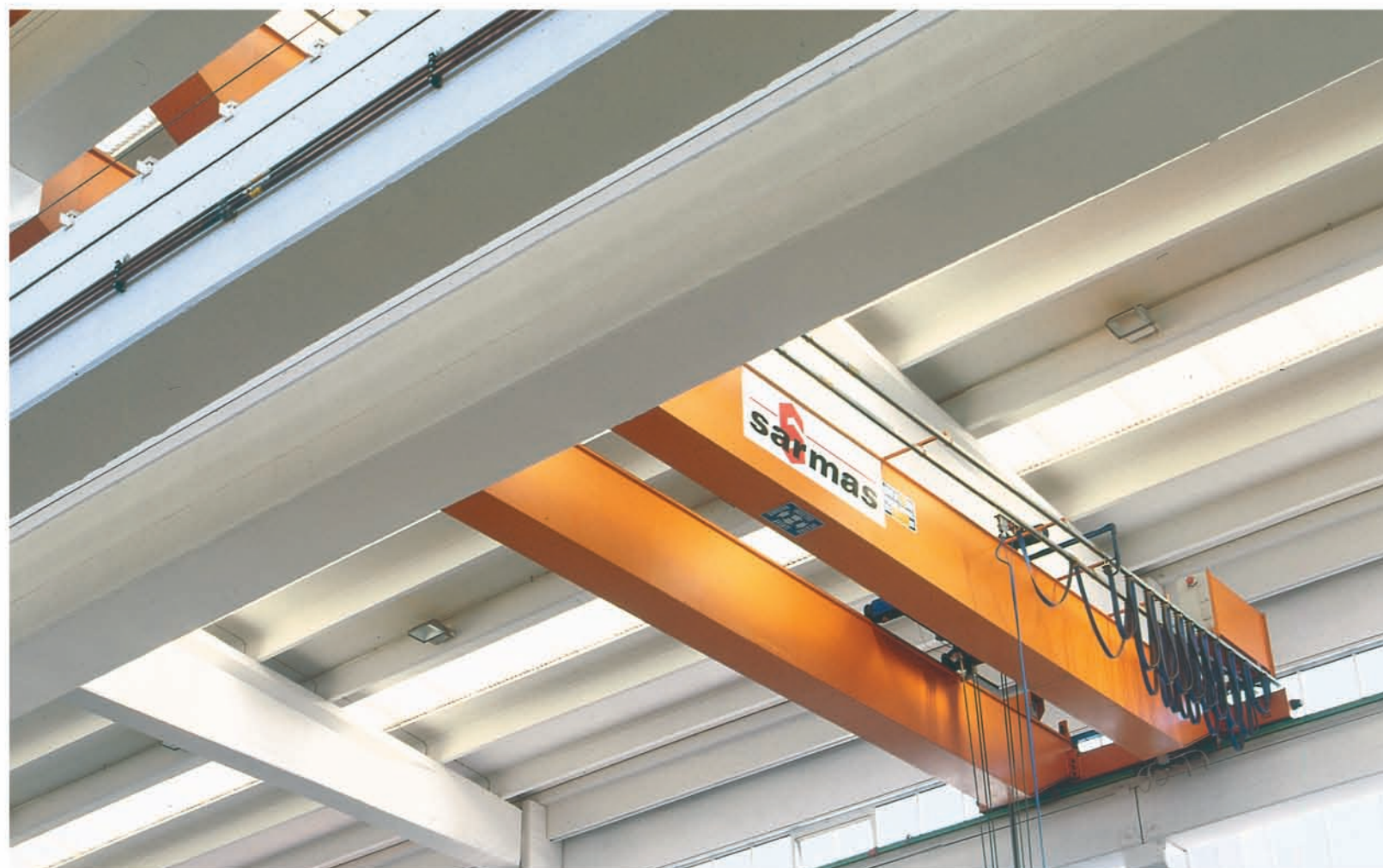
SIMI Lungavilla (Pv). Gru bitrave a cassone Portata 25000 Kg. Scartamento 15 mt.
