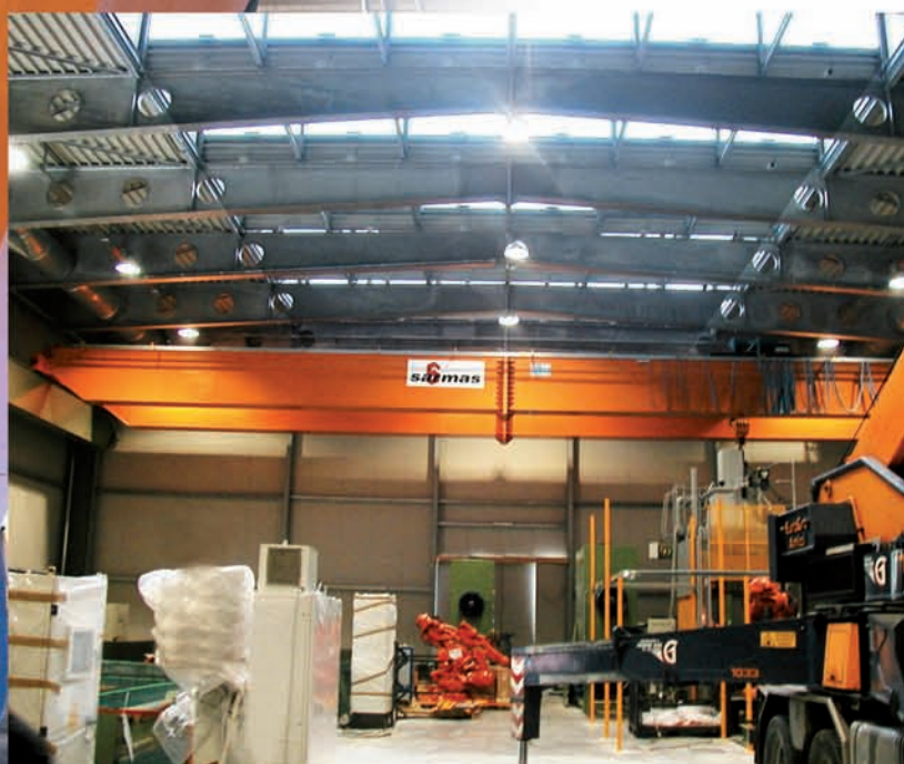
Gruppo Form - Quero (BI). Gru bitrave a cassone con flangia di giunzione. Portata 32000/16000 Kg. Scartamento 25 mt.
